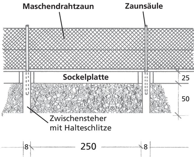
Fundamentsteher für Zaunsäulen aus Stahlrohr mit aufgeschweißten Halteschlitz – verzinkt.
