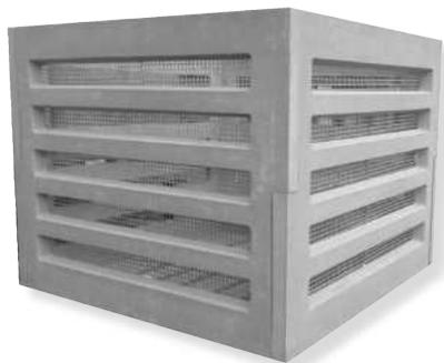
Bestehend aus 4 Einzelteilen, die an den Ecken durch einschieben einer Edelstahlstange verbunden werden. Durch ein an den Innenseiten angebrachtes Lochblechgitter wird ein Herausfallen des Kompostes verhindert.
